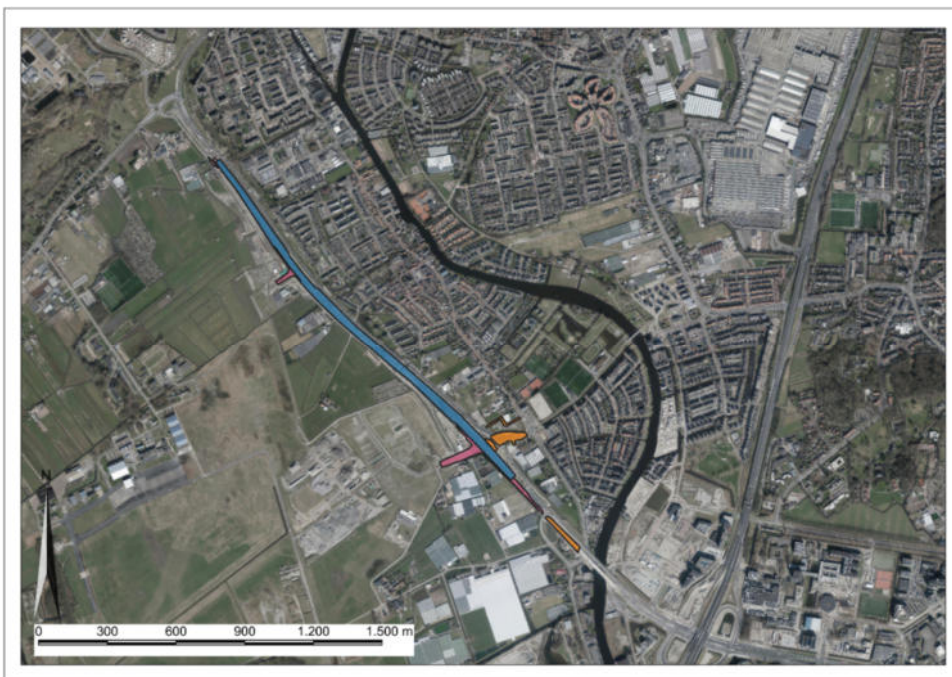
Afbeelding 1.1: Overzicht toepassing Beaumix: blauw- beaumix toegepast in verdiepte ligging, rood – beaumix tijdelijk toegepast, oranje beaumix toegepast in cunet kunstwerk.
