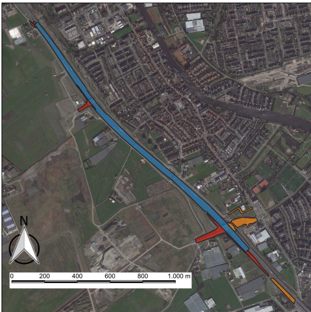
Afbeelding 2.1: Overzicht toepassing Beaumix: blauw- beaumix toegepast in verdiepte ligging, rood – beaumix tijdelijk toegepast, oranje beaumix toegepast in cunet kunstwerk.
